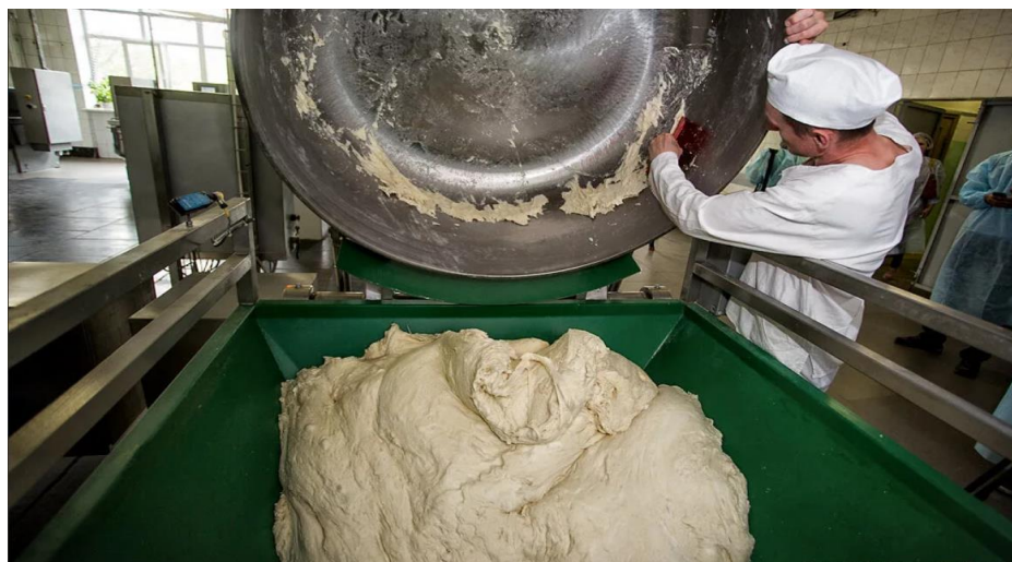
1.4-сурет – Макарон қамырын дайындау процесі
