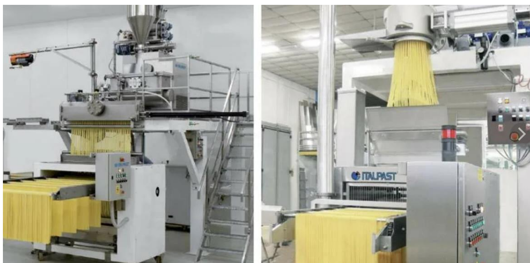
1.8-сурет – Макарон өнімдерін кептіру процесі
