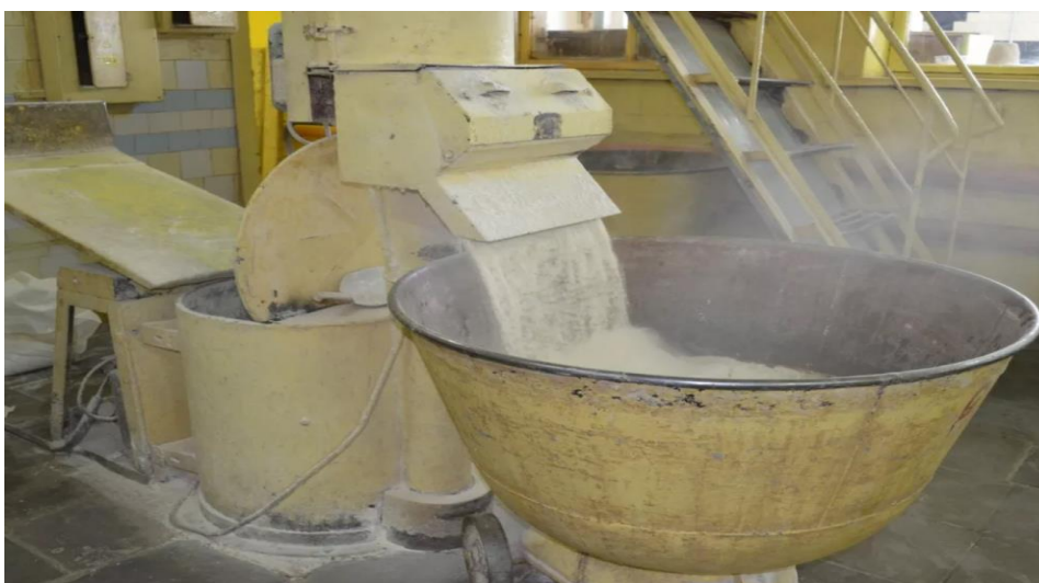
1.3-сурет – Ұнды қамыр илеу процессіне дайындау
