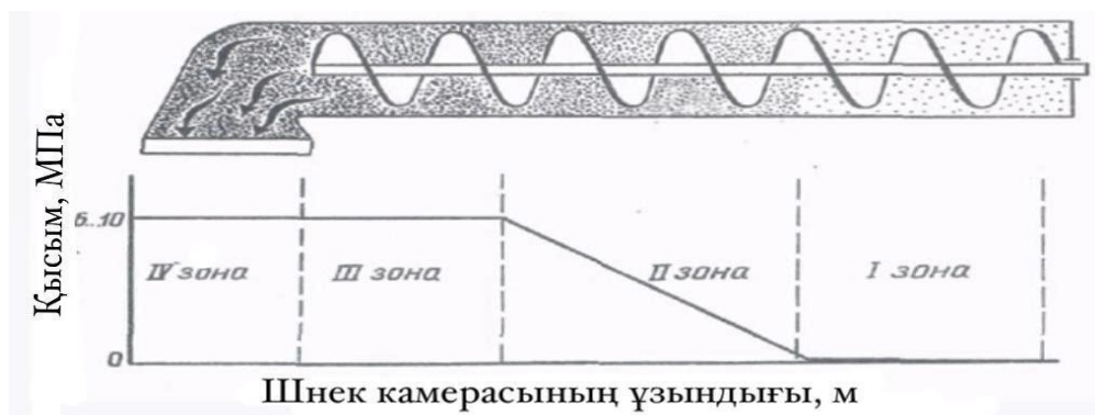
2.1-сурет – Шнектік пресстің пресстеуші құрылғысын зоналарға бөлу
