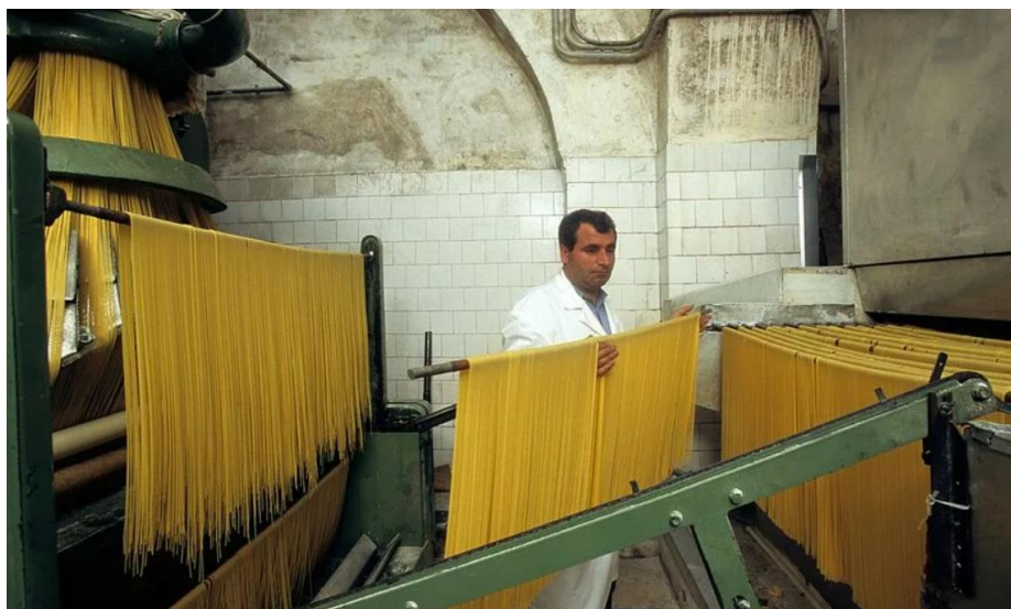
1.9-сурет – Кептірілген өнімдерді арнайы камераларда суыту
