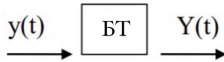
3.16-сурет – Біріншілік түрлендіргіштің құрылымдық схемасы мұндағы y(t) – макарон өнімдерінің ылғалдылығы; Y(t) – БТ-тің шығыс сигналы(0...1).
