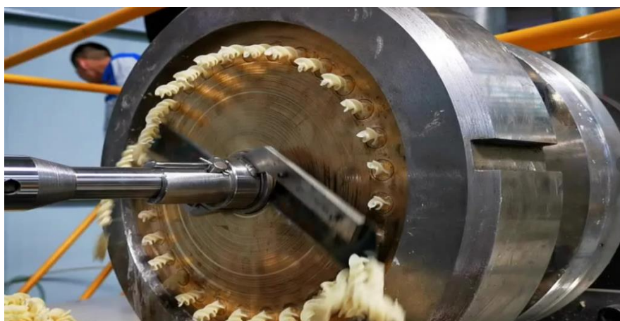
1.6-сурет – «Спираль» макарондарын жасау процесі
